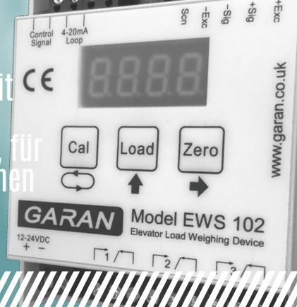
Unsere EWS 102-Kontrolleinheit bietet eine einfache und dennoch leistungsstarke Bandbreite an Optionen für das Wiegen von Lasten. Diese arbeiten mit einer Vielzahl an Sensoren und können unter Verwendung unserer einfachen Schritt-für-Schritt-Einrichtungsverfahren direkt konfiguriert werden. Die Kalibrierung ist simpel und kann entweder anhand einer bekannten Last oder Volllast erfolgen.
