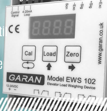
Nuestra unidad de control EWS 102 ofrece una sencilla pero potente gama de opciones de pesaje. Estas opciones funcionan con una gran variedad de sensores y pueden configurarse fácilmente con nuestro sencillo procedimiento paso a paso. La calibración es simple y se puede lograr con una carga conocida o con una carga completa.
